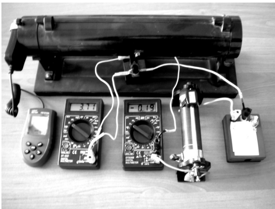
Рис. 3. Експериментальна установка до роботи «Визначення і порівняння питомих потужностей різних джерел світла».
