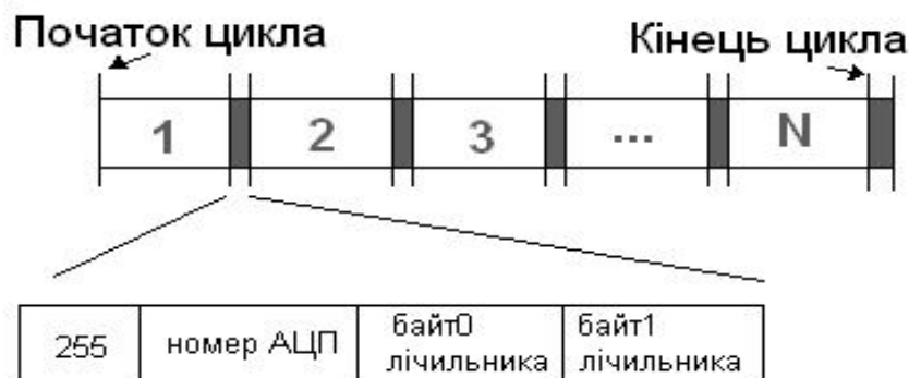
Рис. 1. Зображення потоку даних при пакетній організації передачі даних. На рисунку номер 1...N відповідає послідовності даних, що були виміряні тим АЦП, шапка з номером якого слідує за групою емпіричних даних
