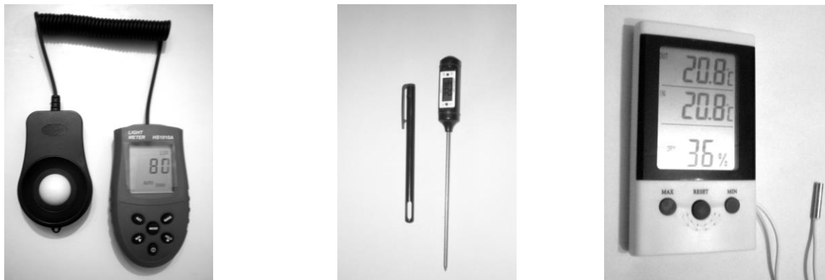
Рис. 1. Цифрові вимірювальні засоби: люксметр, термометр, побутовий психрометр
