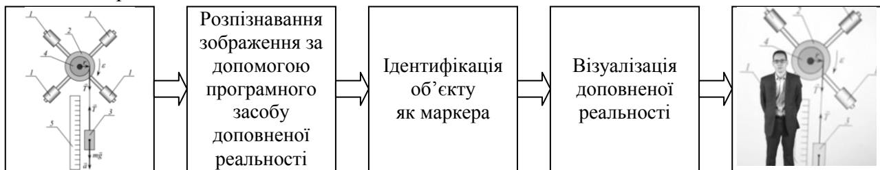
Рис. 3. Схема реалізації доповненої реальності
