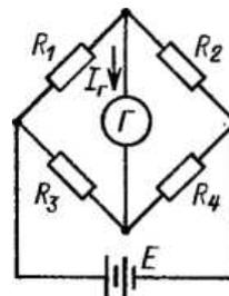
Рис. 2. Схема одинарного четырехплечевого моста постоянного тока
