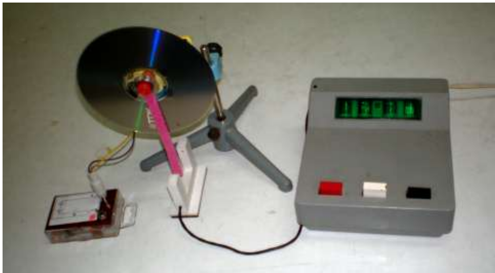
Рис. 2. Лабораторна установка до вивчення обертального руху з використанням фотодатчика.
