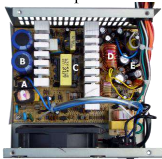
Рис. 3.29. Імпульсний трансформатор (С) в імпульсному блоці живлення персонального комп'ютера. D – дросель групової стабілізації
