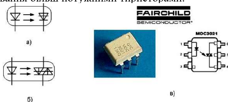
Рис. 6.22. Тиристорні оптрони: умовне позначення оптрона з фототиристором (а) і фотосимістором (б), оптосимістор компанії Fairchild MOC3021 (в)
