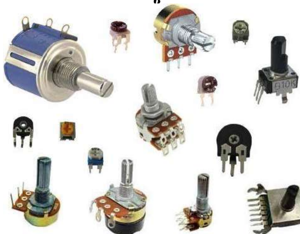
Рис. 3.8. Резистори: а) постійний резистор (умовне позначення) та розміри умовного позначення резистора; б) постійний резистор на схемах імпортованих приладів; в) постійні резистори (зовнішній вигляд); г) змінний резистор (умовне позначення); д) змінні резистори (зовнішній вигляд)
