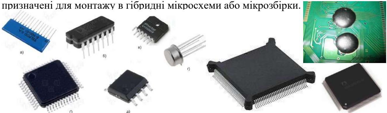
Рис. 7.1. Інтегральні мікросхеми: гібридна мікросхема E100-03H (а), перетворювач – аналогова схема AD536AJQ (б), аудіопідсилювач Lm3886tf (в), операційний підсилювач AD549LHZ (г); схеми для поверхневого монтажу: драйвер для двигунів/контролер IC A3930KJP-T (з), пристрій пам'яті 25LF020A-33SAE (д)
