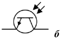
Рис. 6.15. Зовнішній вигляд (а) та умовне позначення (б) фототранзистора
