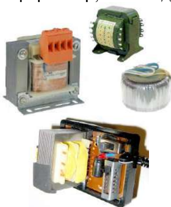
Рис. 3.28. Мережеві трансформатори живлення
