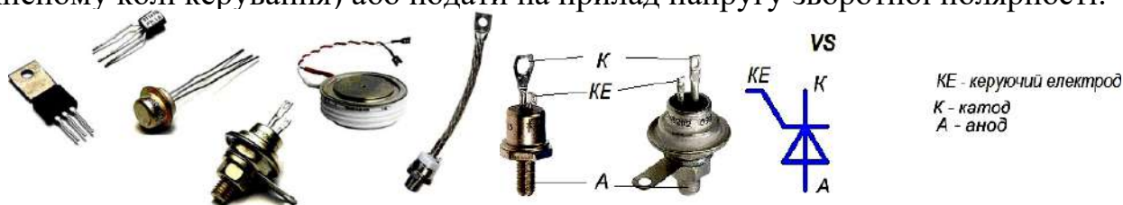
Рис. 5.30. Зовнішній вигляд дискретних триністорів – малопотужні (а), силові з таблетним і штирьовим конструктивним виконанням (б); умовне позначення триністора з керуванням по катоду (в)
