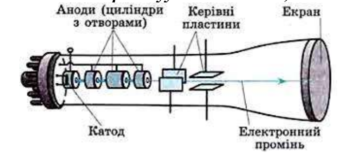
Рис. 3.5. Електронно-променева трубка з флуоресцентним люмінофорним екраном
