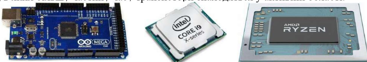
Рис. 7.3. Плата ARDUINO з мікроконтролером ATmega2560, сучасні мікропроцесори
