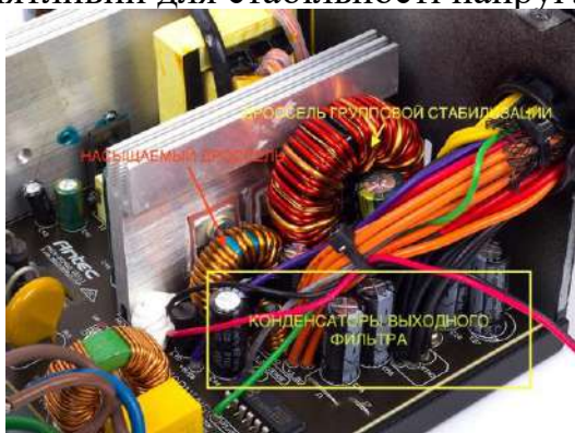
Рис. 8.32. Стабілізуючі дроселі і вихідний фільтр (Antec VP700P)
