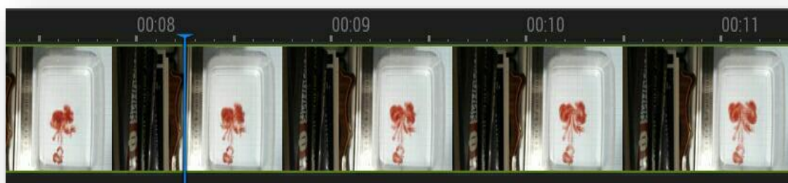
Рис. 1. Утворення вихрового кільця
