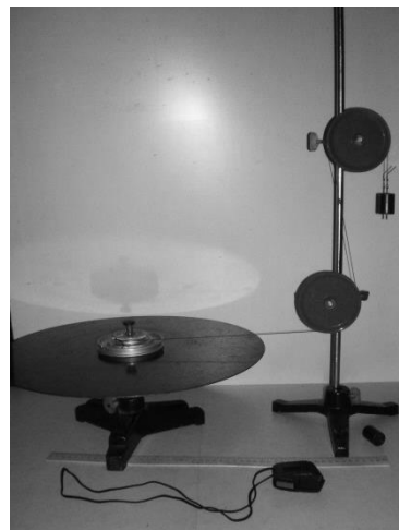
Рис. 1. Установка для перевірки основного рівняння обертового руху
