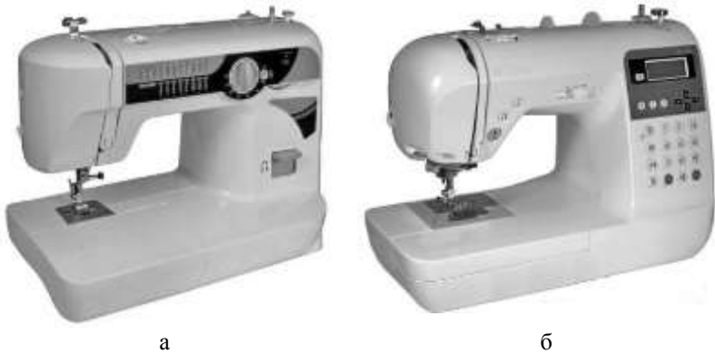
Рис. 1.9. Побутові швейні машини: а - електромеханічна, б - комп'ютеризована
