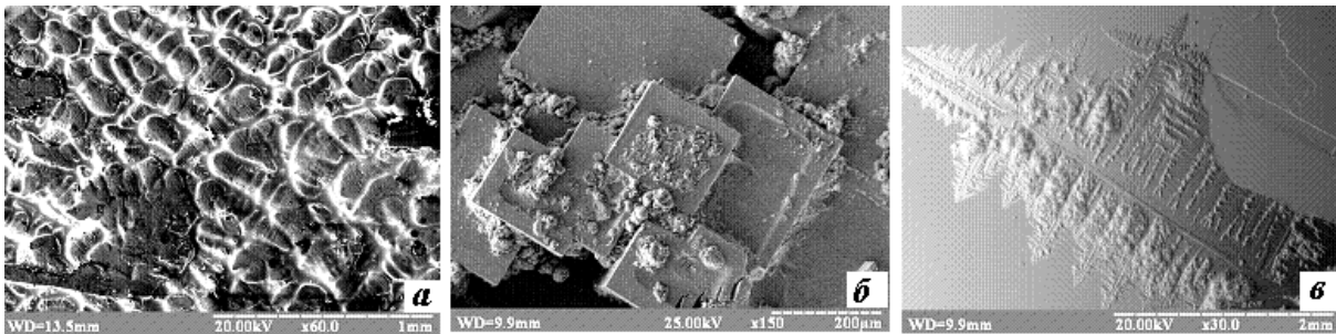
Рис.5.1. Залежність якості поверхні епітаксійних шарів PbSnTe на підкладках PbTeSe від величини переохолодження ростового розчину \Delta T : a – 1 К; b – 6 К; v – 12 К. [фото автора].
