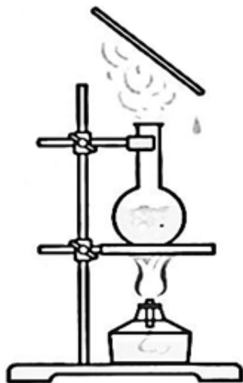
Рис. 1. Кипіння, випаровування й конденсація води
