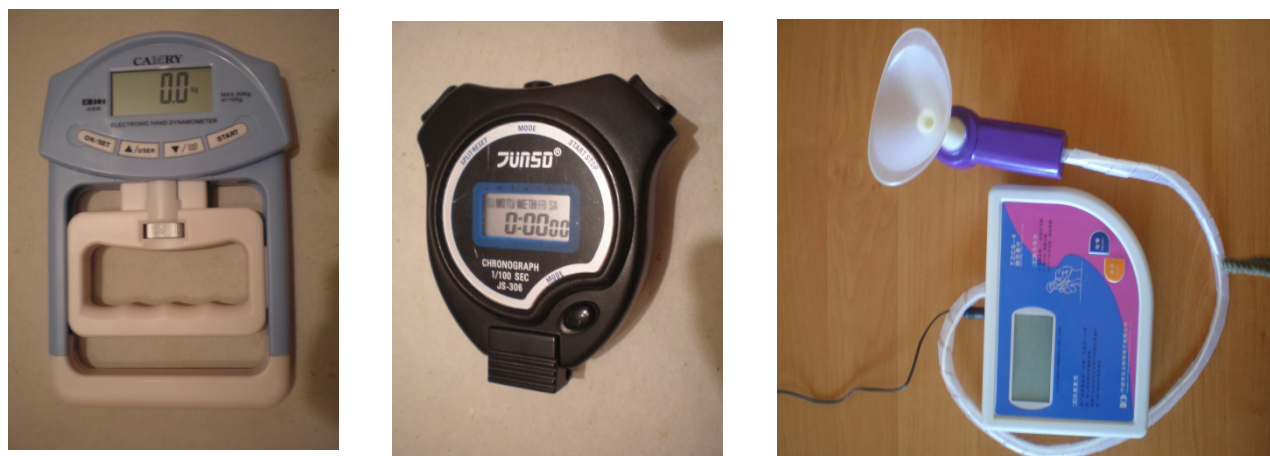
Рис. 2. Плоскопружинний динамометр, цифровий секундомір і спірометр.
