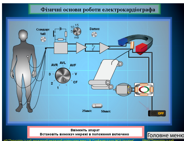
Рис.1. Фізичні основи роботи електрокардіографа.
