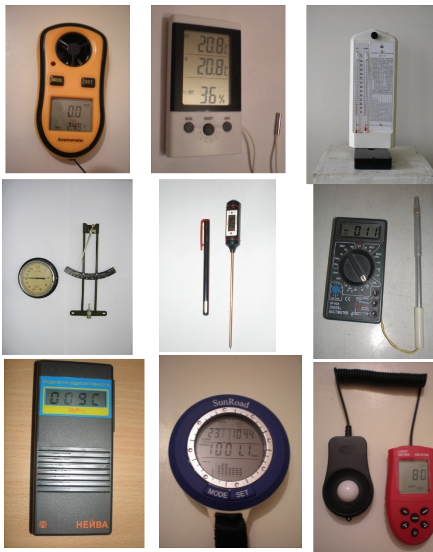
Рис. 1. Традиційні і сучасні зразки вимірювальних приладів: анемометра, термометра-гігрометра, психрометра, волосяного гігрометра, цифрових термометрів, вимірювача радіоактивності, барометра і люксметра.
